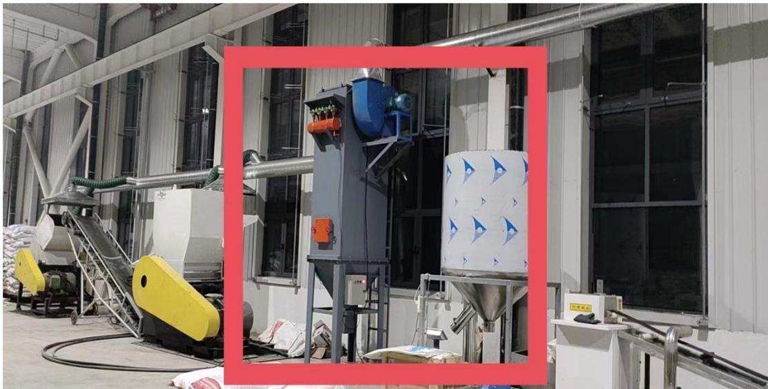
破碎撕碎、上料混合工序布袋除尘器
